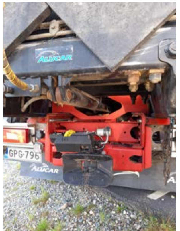
Rockinger RO 50 Servolla, 95 ast. vain kytkettyinä kääntyvällä vetokidalla sekä kameralla, joka asennetaan suojaalvyineen vetokitaan.
