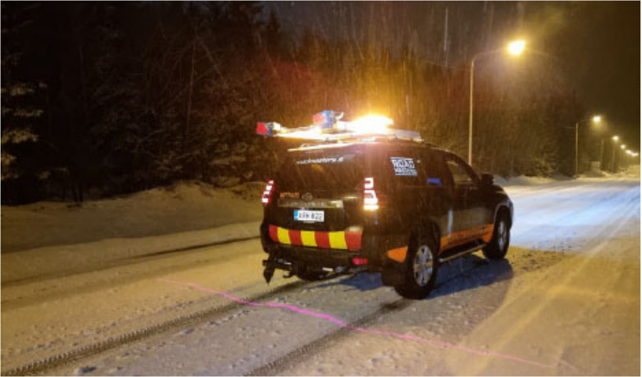
Kuva 12. Mittaus tiellä 624. Hämärässä laserien mittauskohda on helppo havaita. Väyläviraston julkaisuja 71/2022.
